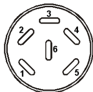
Abb. 10: Pinbelegung der DIN-Buchse für Option Analogausgang
